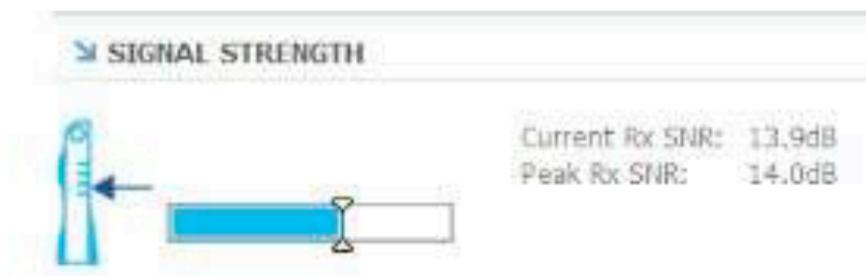
Fig.6-13 - Particolare misurazione segnale ricevuto
