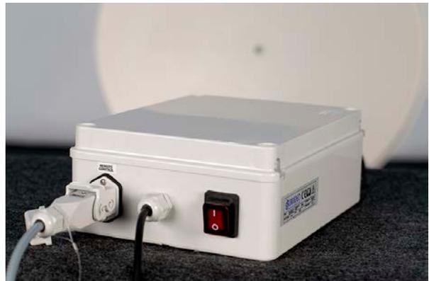
Fig.6-3 - Connettore Telecomando - Interruttore On/Off
