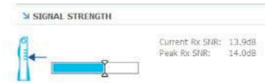
Fig.4-11 - Particolare misurazione segnale ricevuto
